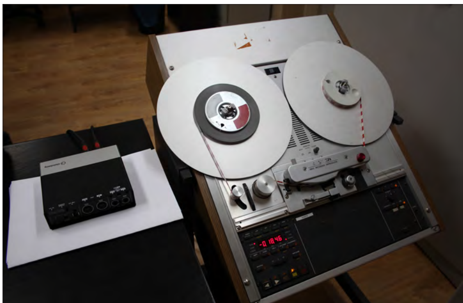
21. Zestaw do digitalizacji taśm magnetycznych – radiowy magnetofon studyjny wraz z konwerterem – Fot. M. Lupa.
