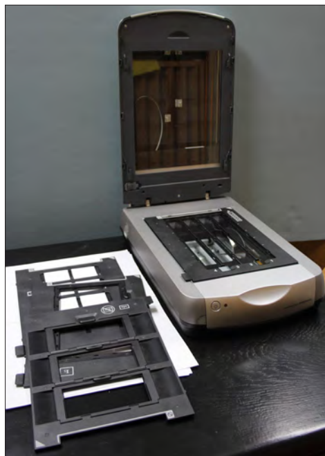
20. Skaner płaski A4 wyposażony w ramki do skanowania filmów fotograficznych – Fot. M. Lupa.
